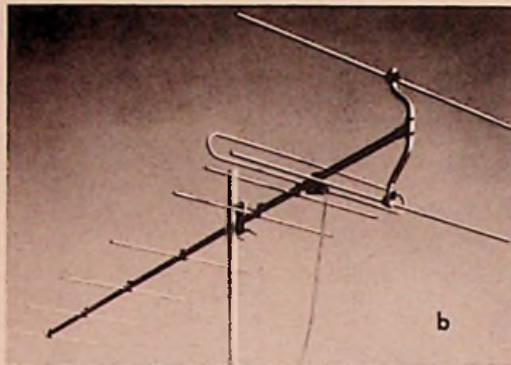
b) ausgebaute Antenne nach Anbringen des vierteiligen Direktorvorsatzes und des Reflektorvorsatzes
